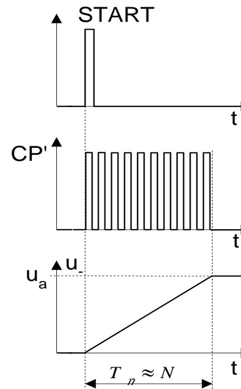
**Primjer : Frekvencija oscilatora iznosi 100MHz. Za 10-bitni pretvornik odrediti vrijeme pretvorbe  $t_c$ .**
