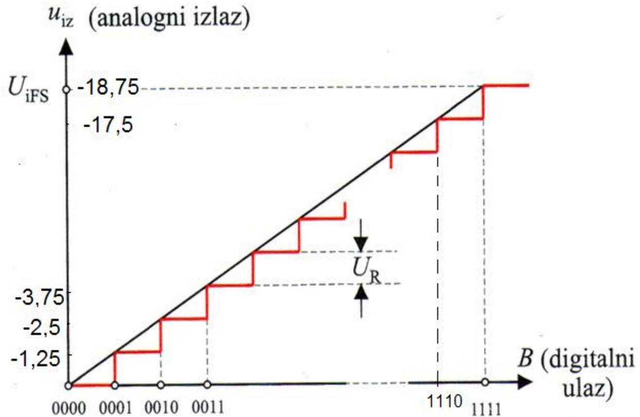
**Zadatak: Nacrtati shemu 4-bitnog DA pretvornika , te odrediti iznos izlaznog napona uz dovedenu binarnu kombinaciju na ulaze 1100 , ako je napon rezolucije 0,2V. Odrediti i vrijednosti otpornika ako je na bitu najveće težinske vrijednosti (MSB) iznos otpornika 1 kΩ.**
