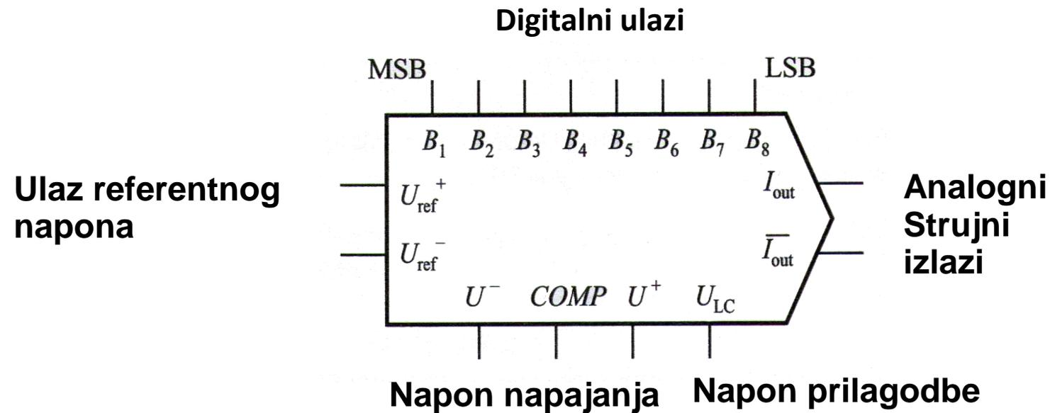
**Primjer :Ako je na ulazu 6-bitnog DA pretvornika binarni broj 101011, na izlazu je napon od -1,5V. Odrediti izlazni napon za stanje ulaza 110001.**
